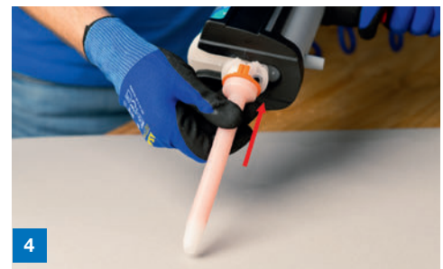
4 Material abwischen und Statikmischer aufsetzen
