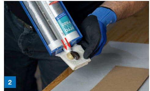
Material ohne Statikmischer ausdrücken bis bei beiden Öffnungen Material austritt
