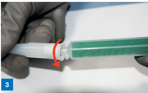
3 Standardkartuschendüse mit Gewindeaufsatz gerade auf die Statikmischerspitze aufsetzen und auf die glatte Fläche „aufschrauben“
