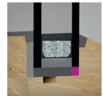
Abdichtung am Flügelrahmen hinter der Glashalteleiste
