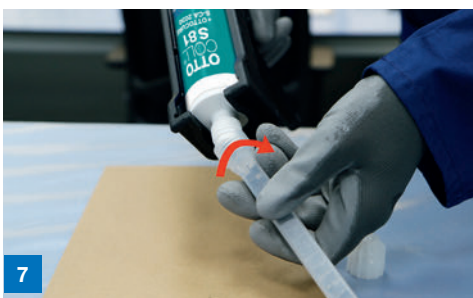
7 Material abwischen und OTTO Statikmischer MGQ 10-16D bis zum Anschlag aufschrauben
