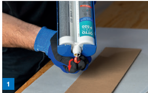
Einlegen der Kartusche in die Pistolenschale, Schutzkappe abschrauben und Stöfen entfernen
