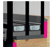
Stufenklebung auf Position 2
