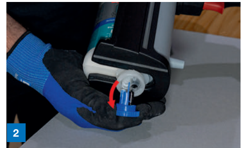
2 Stopfen abschrauben und entfernen
