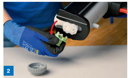
2 Überwurfmutter abschrauben und Stopfen entfernen
