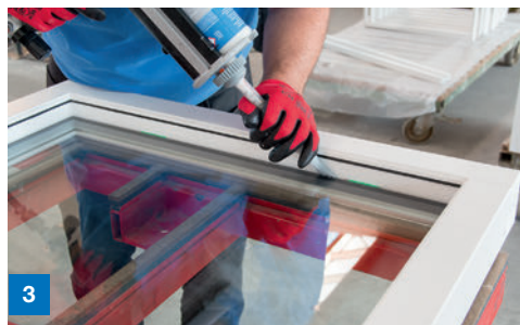
3 Befüllen des Falzgrundes mit Klebstoff
