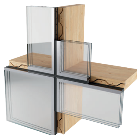
Schematischer Aufbau einer HGV-Fassade
