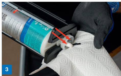
3 Material ohne Statkmischer ausdrücken, bis bei beiden Öffnungen Material austritt
