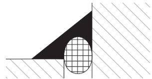
Boden-Wand-Fugen werden als Dreiecksfuge ausgeführt. Für eine fachgerechte Erstellung ist eine Rundschnur zur Verhinderung der Drei-Flanken-Haftung einzubringen.
