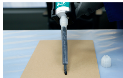
Raupenaustrag und Homogenität der Mischung prüfen (siehe Verarbeitungsbegleitende Qualitätskontrollen 2K-Produkte)
