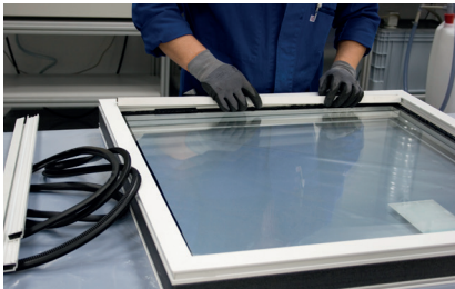
Einlegen der Glashalteleisten
