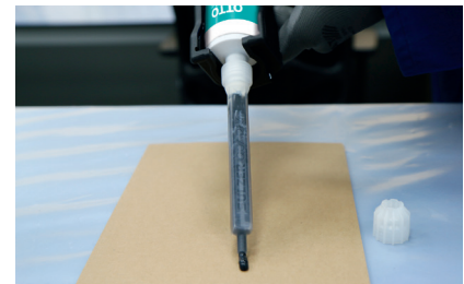
Raupenaustrag und Homogenität der Mischung prüfen (siehe Verarbeitungsbegleitende Qualitätskontrollen 2K-Produkte)
