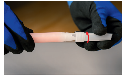
Standardkartuschendüse bis zum Anschlag auf den Statikmischer für BlueLine Kartuschen aufschrauben
