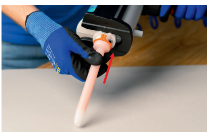
Material abwischen und Statikmischer aufsetzen
