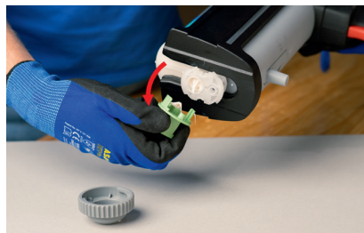
Überwurfmutter abschrauben und Stopfen entfernen
