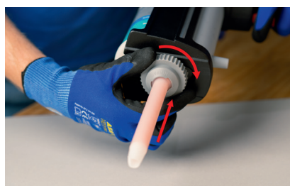
Statikmischer mit der Überwurfmutter fixieren
