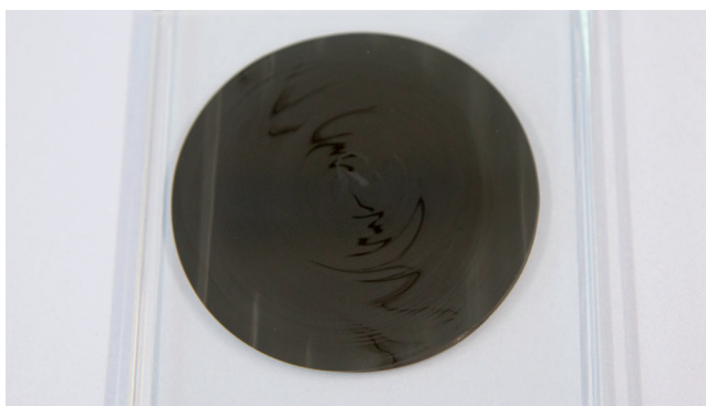
Glasplattentest – Zu erwartendes Mischbild bei Kartuschenverarbeitung
