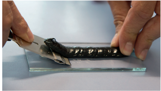
Einschneiden zwischen Klebstoff und Glasscheibe
