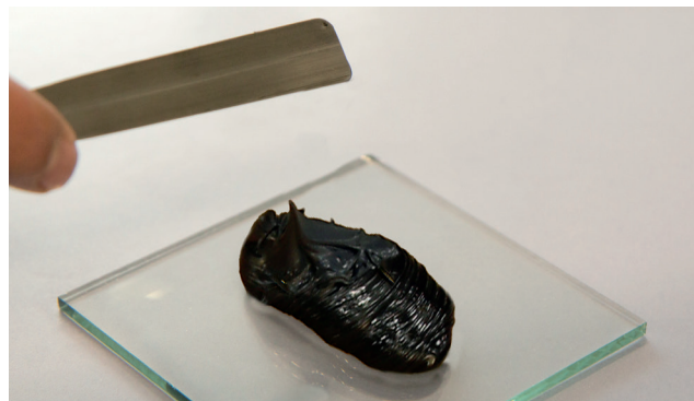
Konsistenz „kaugummiartig“, der Dichtstoff „zieht zurück“ -> Topfzeit ist erreicht
