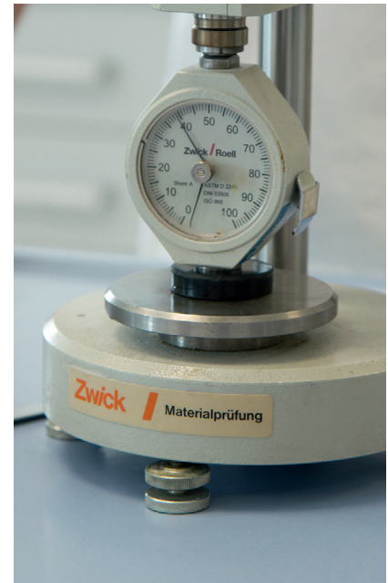
-> Messung der Shore A Härte mit einem Durometer!
