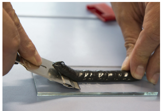
Einschneiden zwischen Klebstoff und Substrat
