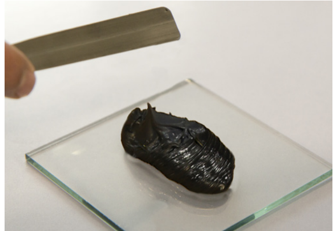
Konsistenz „gummiartig“, der Dichtstoff „zieht zurück“ → Topfzeit ist erreicht
