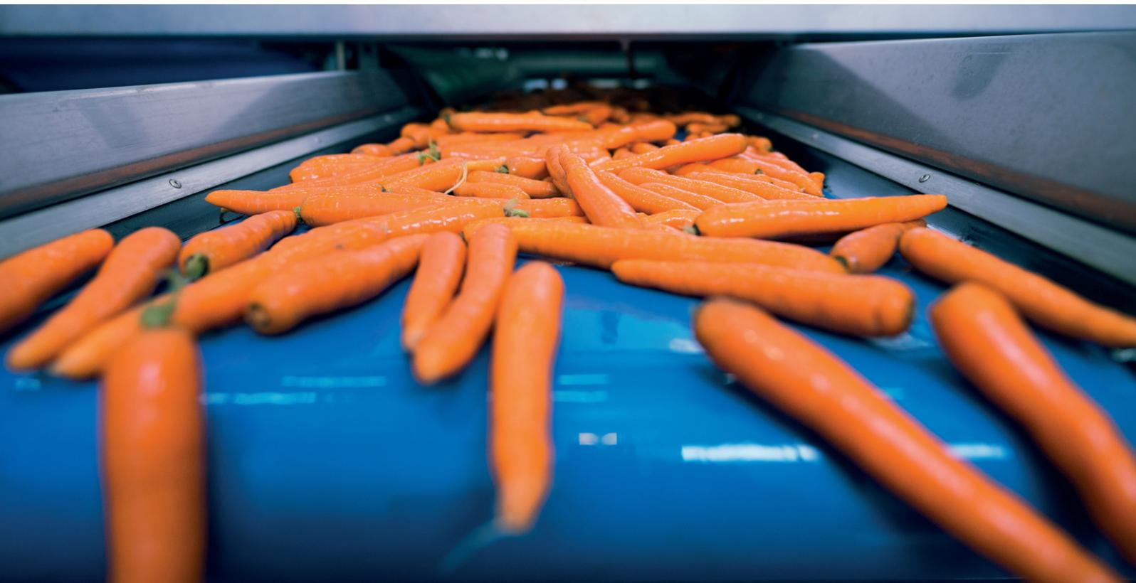
Les installations de productions sont soumises à de nombreuses contraintes de mouvement. Le traitement des aliments, la vitesse, les rayons de déviation, impliquent des contraintes et exigences importantes pour la surface des bandes transporteuses. Novasil® propose une solution à élasticité durable garantissant une forte résistance à l'abrasion et aux contraintes mécaniques.
