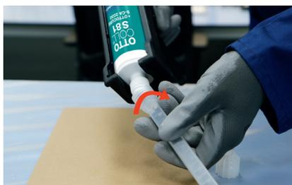
Essuyer le matériau et visser le OTTO mélangeur statique MGQ 10-16D jusqu'à la butée
