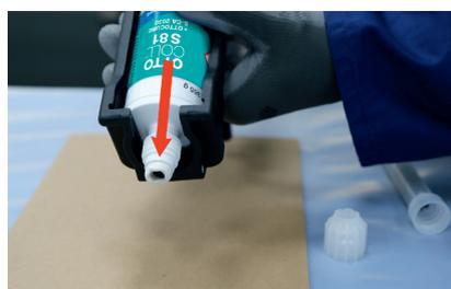
Faire sortir le matériau **sans** mélangeur statique, jusqu'à ce que le matériau sorte par les **deux** ouvertures
