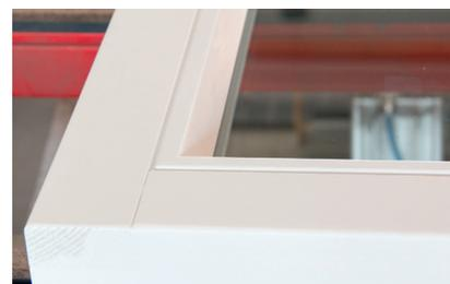
Insertion du joint de vitrage
