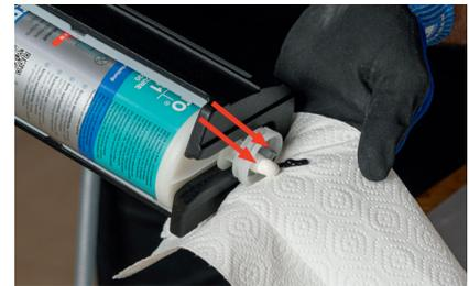
Faire sortir le matériau **sans** mélangeur statique, jusqu'à ce que le matériau sorte par les **deux** ouvertures
